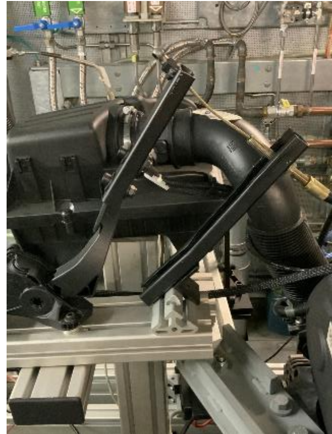
Gaspedal \leftrightarrow Fahrhebelversteller zur Einstellung der Motorlast auch Winkel genannt in %
